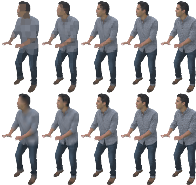
Figura 10. Suavizando o conjunto de dados para p = 1 (RAHT, superior) e p = 2 (BV, inferior), nos níveis 4 (esquerda), 5, 6, 7 e 8 (direita) [Chou et al. 2019]
