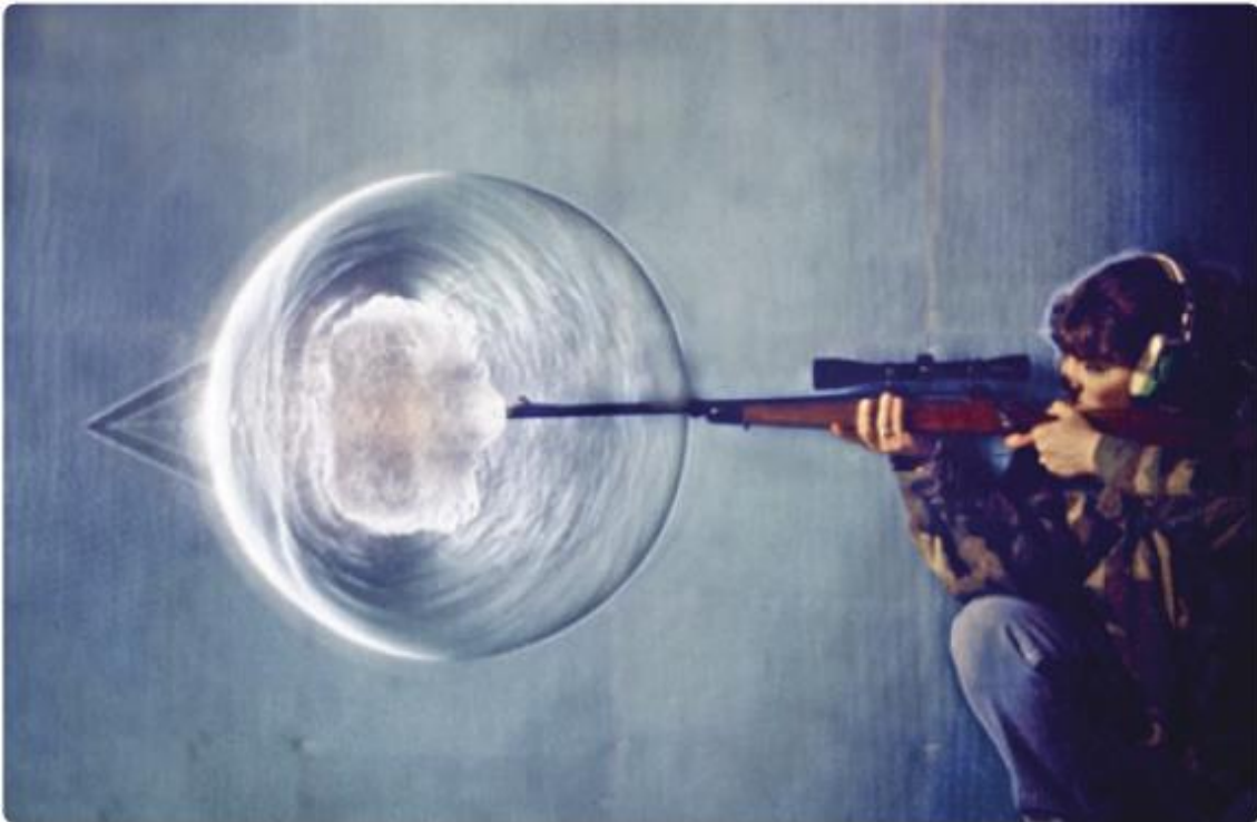
Figura 1 – Imagem real da onda de choque gerada pelo estouro do cano(muzzle blast) e pelo projétil mais rápido que a velocidade do som, que é de aproximadamente 340 m/s. https://www.americanscientist.org/article/high-speed-imaging-of-shock-waves-explosions-and-gunshots
